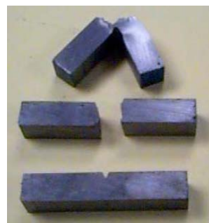
Izgled polomljene i cele epruvete
