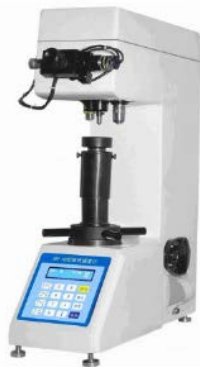
Uređaj za ispitivanje tvrdoće po Vickers-u
