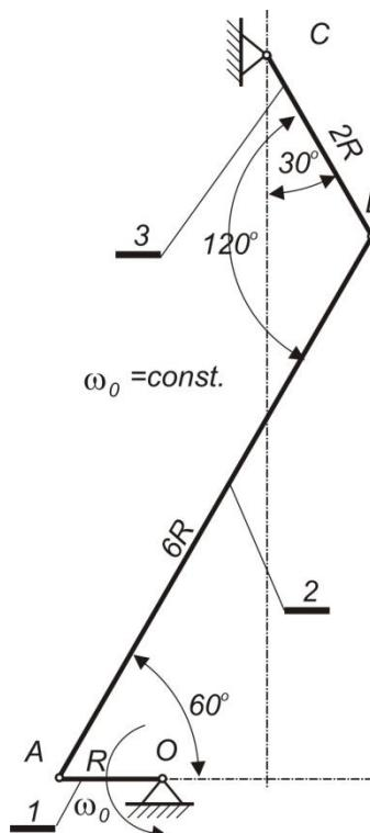
Mehanizam se sastoji od poluge 1, dužine R, koja se obrće konstantnom ugaonom brzinom  $\omega_0$  oko centra O, zatim poluge 2 dužine 6R i poluge 3 dužine 2R. U tačkama A, B, C, O su zglobne veze. Mehanizam se kreće u ravni oko nepokretnih osa kroz tačke O i C upravnih na ravan mehanizma.
