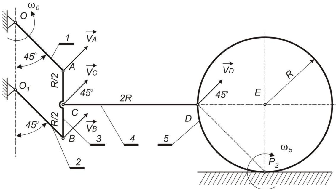
Brzina tačke D poluge je ista sa brzinom tačke D diska i paralelna je sa pravcem brzine tačke C poluge 4 pa su projekcije brzina na pravac CD i na normalan pravac
