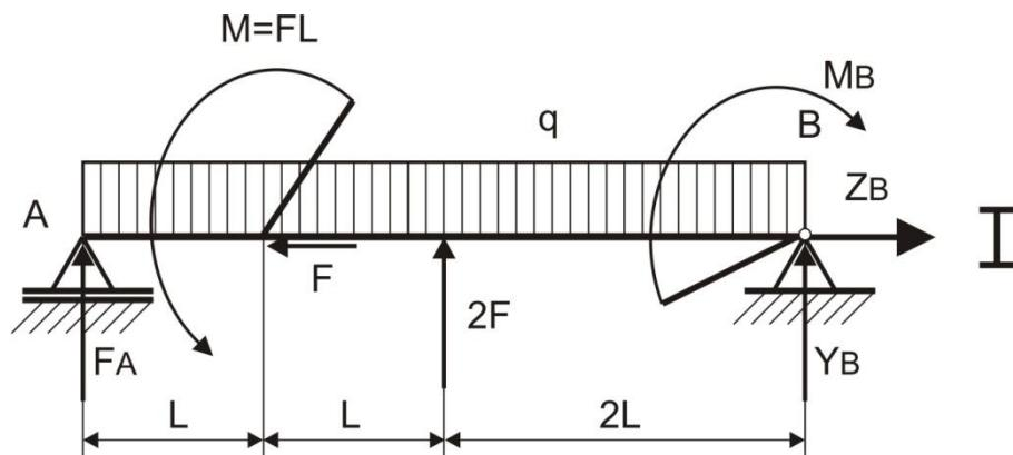
$$F=1\text{ kN}, \quad q=1\text{ kN/m}, \quad L=1\text{ m}$$
