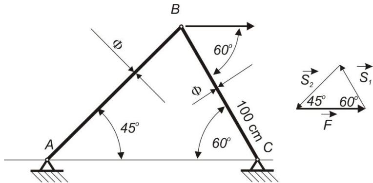
Iz poligona sistema sučeljnih sile (tri sile koje se seku u jednoj tački) primenom sinusne teoreme na trougao sile može se dobiti sila u štapovima
