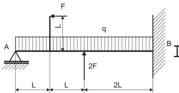
$$F=1 \text{ kN}, q=1 \text{ kN/m}, L=1 \text{ m}$$
