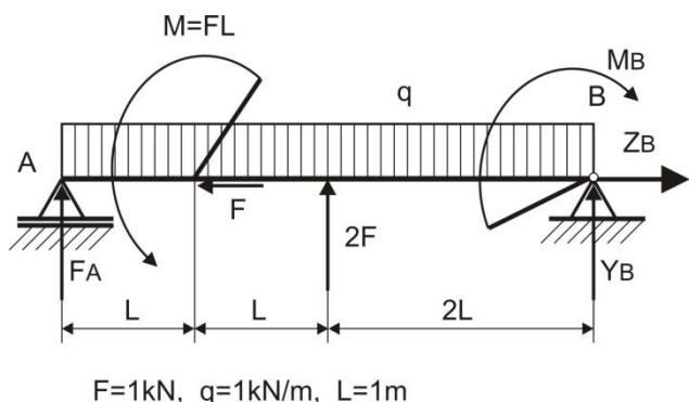
$$F=1 \text{ kN}, q=1 \text{ kN/m}, L=1 \text{ m}$$
