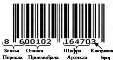
Слика 6.1 Пример EAN означавања
