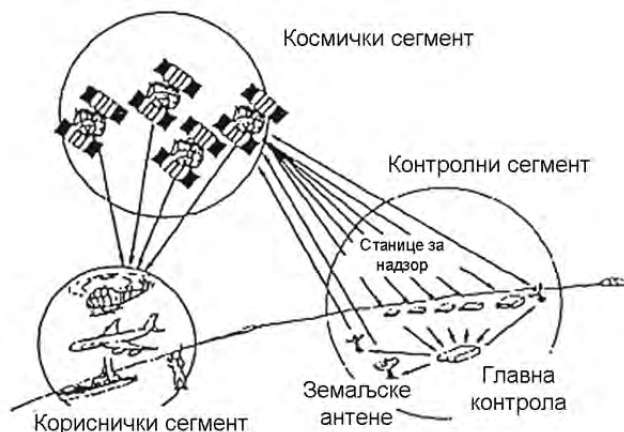
Слика 6.18 Три сегмента GPS система
