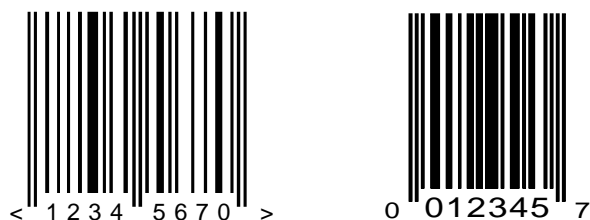
Слика 6.2. EAN-8 и UCC-E означавање
