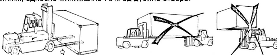
Слика 3.41 Хватање контемера виљушкама
