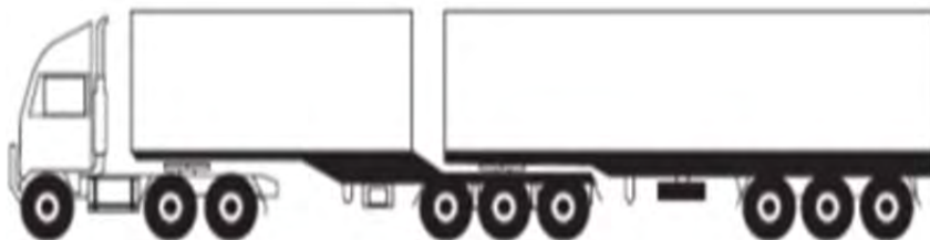
Слика 4.37 B-Double склоп возила
