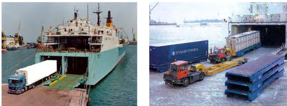
Слика 4.15 Ro-Ro класична и применом касета технологија
