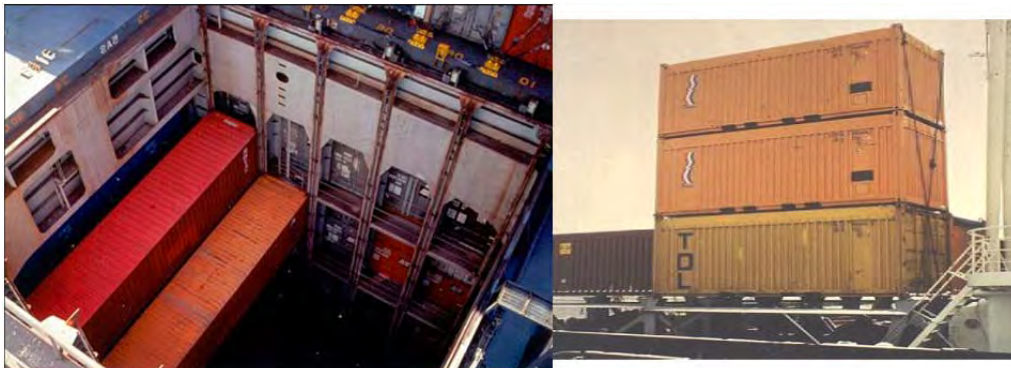
Слика 3.36 Бродско складиште са вођицама и повезивање конテナ на палуби затезним шипкама
