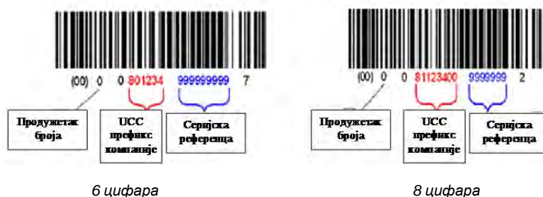
Слика 6.6 Пример једног SSCC са UCC префиксом компаније од 6 и 8 цифара
