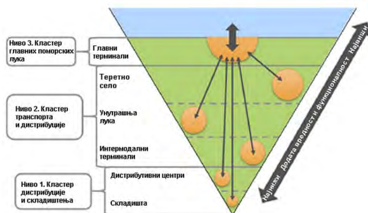
Слика 5.4 Хијерархијски положај терминала
