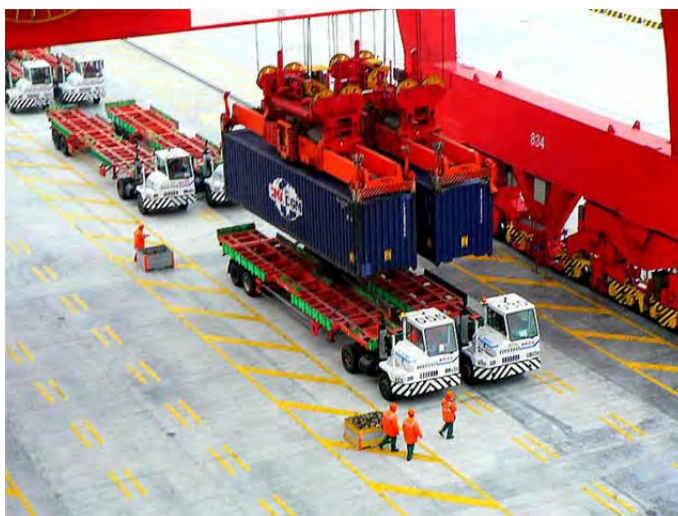
Слика 4.33 Захватање спрегнутим спредерима
