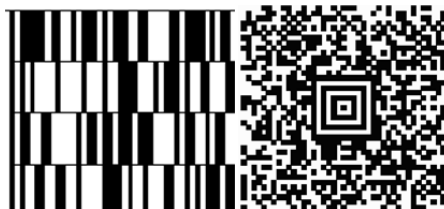
Слика 6.3 Stacked (Code 4) и Matrix симболигија
