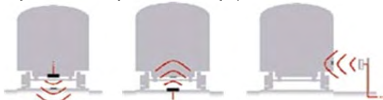
Слика 6.14 Могући начини постављања RFID тага и читача у железничком саобраћају
