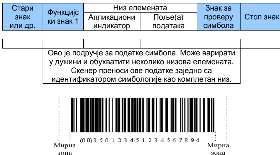
Слика 6.5 Основна структура EAN.UCC - 128 бар код система
